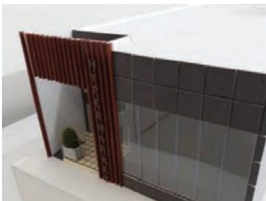
شکل ۵-۸۸- ساخت نمای شیشه‌ای با استفاده از طلق شفاف و ایجاد شیار بر روی آن
