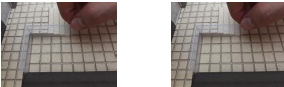
شکل ۵-۱۰۷- نرده: ایجاد خطوطی با کاتر بر روی پلکسی به منظور نمایش میله های نرده
