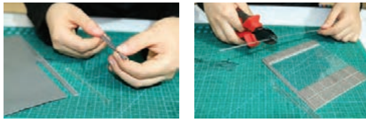
شکل ۵-۸۵- برش قطعات طلق شفاف برای ساخت نمای شیشه ای
