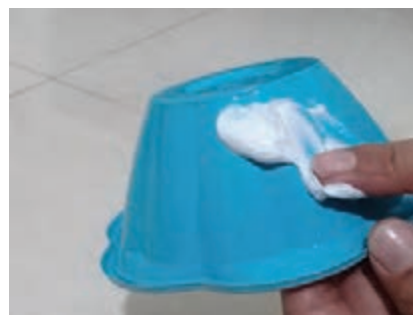
شکل ۴۳-۵- آغشته کردن مدل با ماده جداکننده (مایع ظرفشویی یا وازلین)
