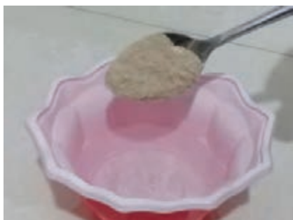
شکل ۴۴-۵- آماده کردن چسب سریشم و مخلوط کردن آن با آب
