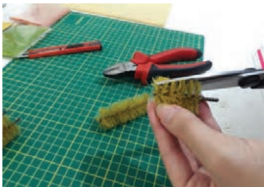
شکل ۵-۱۱۶- برش فرچه و فرم‌دهی به آن برای درست کردن درخت
